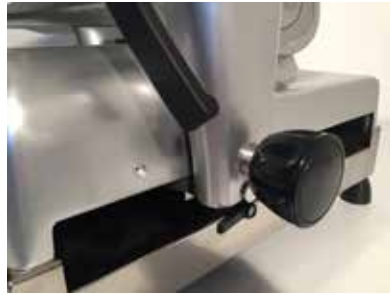
Leva di sgancio carrello per l'utilizzo in manuale.
