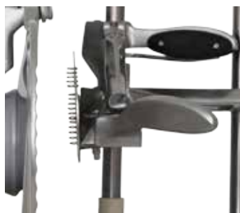
Ciabatta in acciaio inox smontabile.
