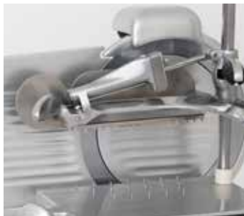
Braccio pressamerce con puntine in acciaio inox.
